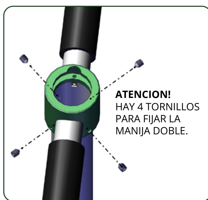
Figura 04 Proceso de fijación de los 4 tornillos.
