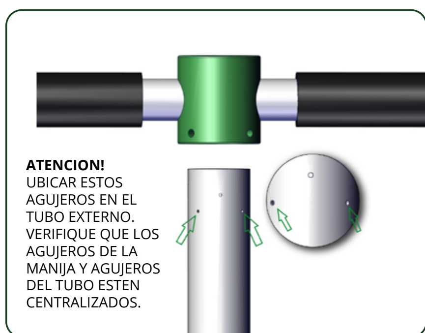
Figura 01 Colocación de doble manija en los orificios del tubo exterior.
