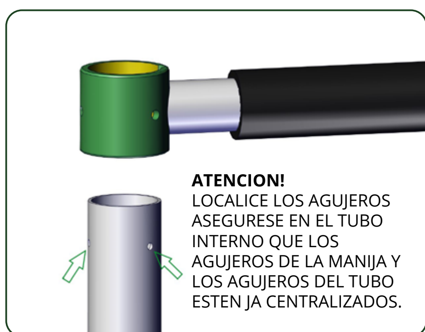
Figura 06 Colocación de una sola manija en los orificios del tubo interior para la fijación.
