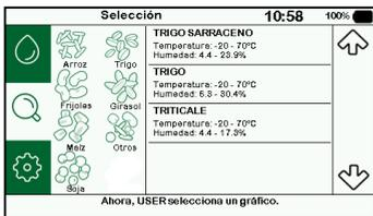
Seleccionada la curva, el medidor volverá a la pantalla **MEDICIÓN**.
